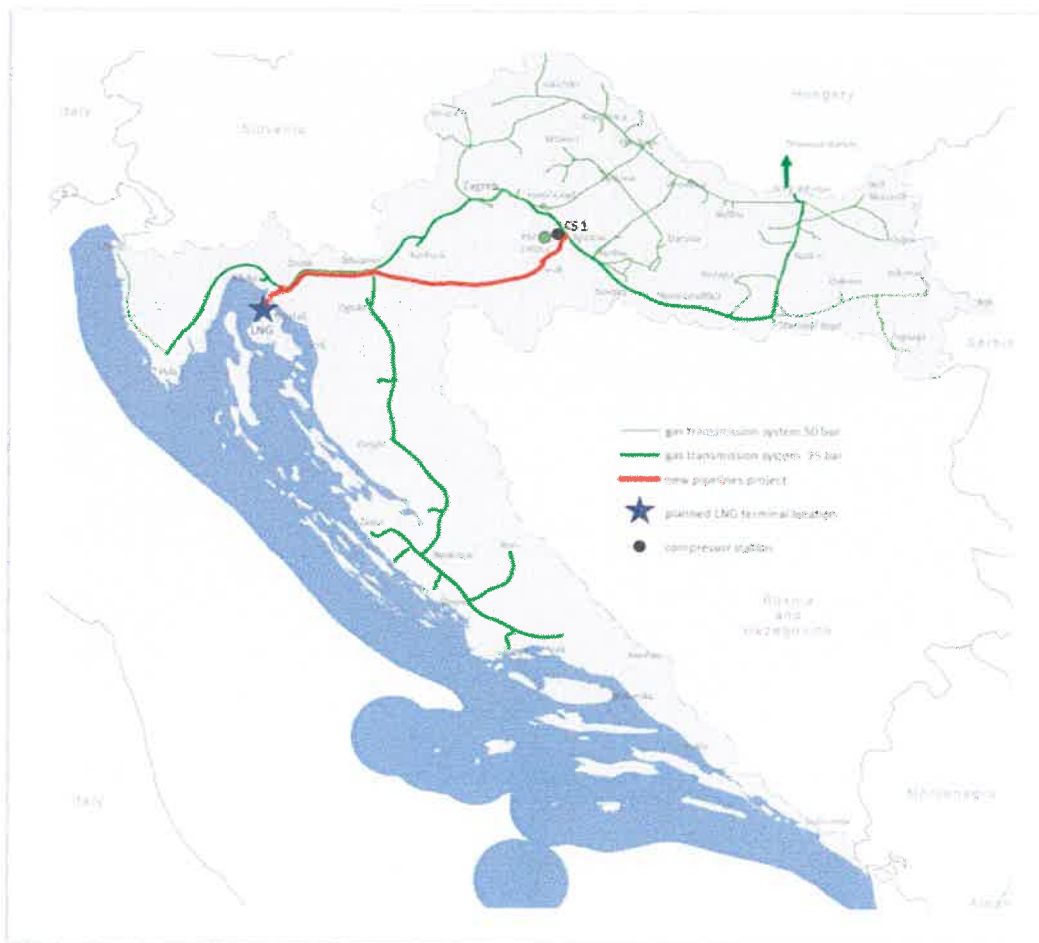
2 A Plinacro meglévő földgázszállító rendszere, a cseppfolyósított földgázterminál elhelyezkedése, CS1 és az Omišalj-Zlobin-Bosiljevo-Sisak-Kozarac földgázvezeték
